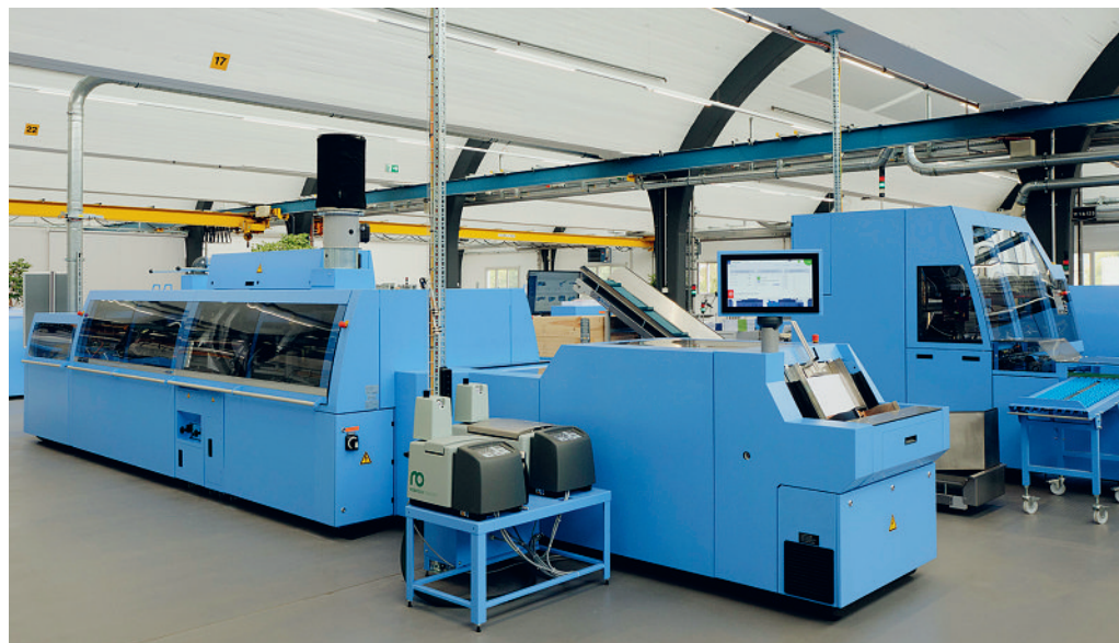
In der Variante 'Digital' verarbeitet der neue Klebebinder Antaro (links) 2000 Buchblocks oder Broschüren pro Stunde. Damit liegt er leistungsmässig mit dem Dreiseitenschneider InfiniTrim (hinten rechts) gleichauf.
